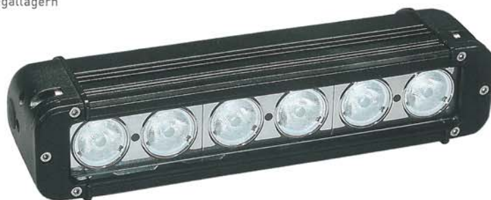
LCC-Balkenscheinwerfer BS060, 4350 lm 6000K 20° IP68, 9-48 VDC 60 W, Arbeitsscheinwerfer für Fahrzeuge, Beleuchtung in Hochregallagern
