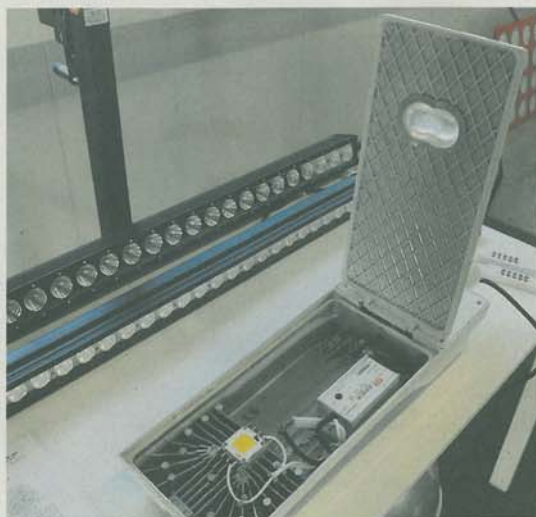
Mit einem Retrofit können selbst bestehende Strassenlaternen auf die LCC-Technik nachgerüstet werden.
