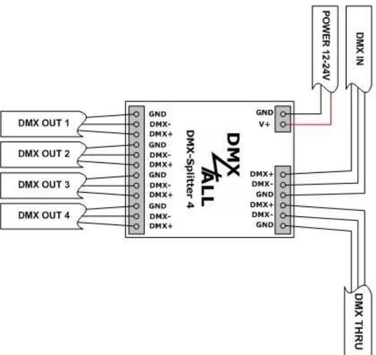
Werden mehr als 4 DMX-Ausgänge benötigt, so können mehrere der DMX-Splitter 4 wie folgt kombiniert werden:
